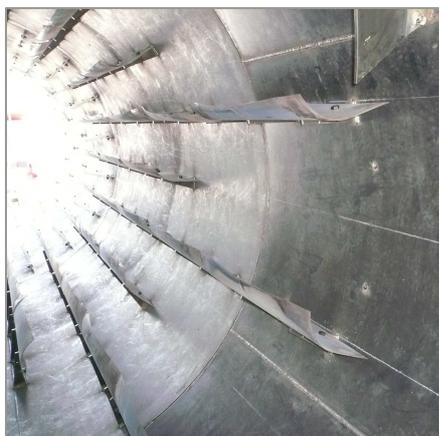
**羽根自体の振動で再生材を払い落とし、付着の進行を抑えます。**
