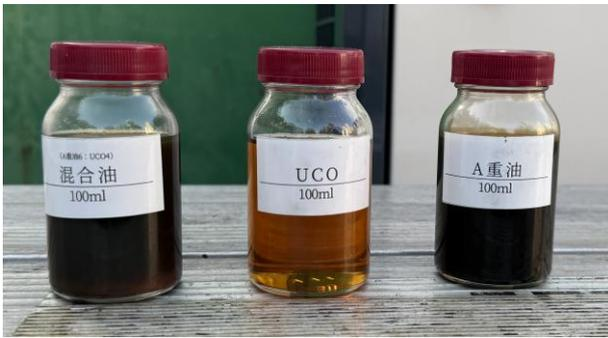
↑ 右から A 重油、真ん中が廃食用油、左端が重油 6 : 廃食用油 4 を混ぜた UCO 混合油。分離せず、冷えても問題なく使える。
