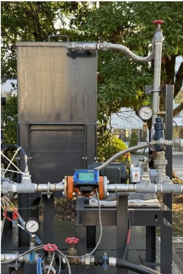
**↑ 燃焼装置に接続された混合燃料タンクとノズル**
