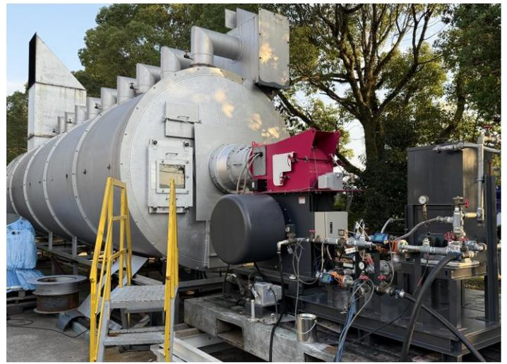
**廃食用油燃料の燃焼装置 ↑→**
